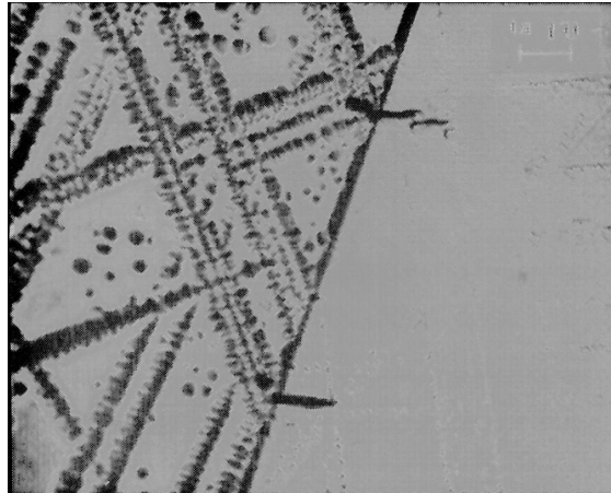
Figuur I.4.10. Haarscheurtjes bij doorbraak van een korrelgrens. De enorme pile-up van dislocaties is goed zichtbaar. Foto van etsputten in onbekend materiaal.
