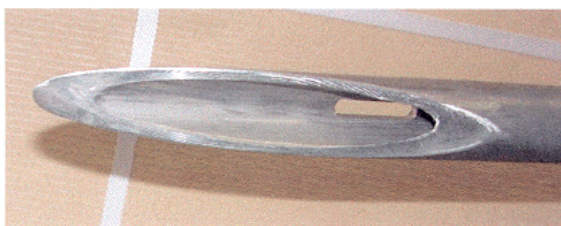
a. Bovenaanzicht afgezaagd slijtstuk
