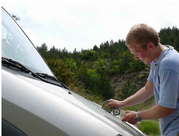
Figuur 3.8. Max Daarnhouwer meet de hellingshoek van de motorkap...
